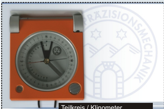
Teilkreis / Klinometer Graduated Circle / Clinometer
